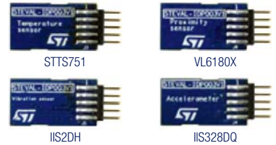
図9 : センサ・ドータ・ボードは上段の左から時計周りに、STEVAL-IDP003V1T、STEVAL-IDP003V1P、STEVAL-IDP003V1A、STEVAL-IDP003V1TV 対応する製品名は、各写真の下に記載
