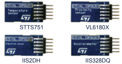
图9 – 传感器子插件板（不按比例），从左上角按顺时针方向：STEVAL-IDP003V1T、STEVAL-IDP003V1P、STEVAL-IDP003V1A和STEVAL-IDP003V1V。图中已经标出相应的传感器部件编号。
