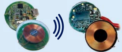
STEVAL-ISB038V1 ウェアラブル用STWBC-WA & STWLC04搭載ワイヤレス・チャージャー リファレンス・デザイン・キット
