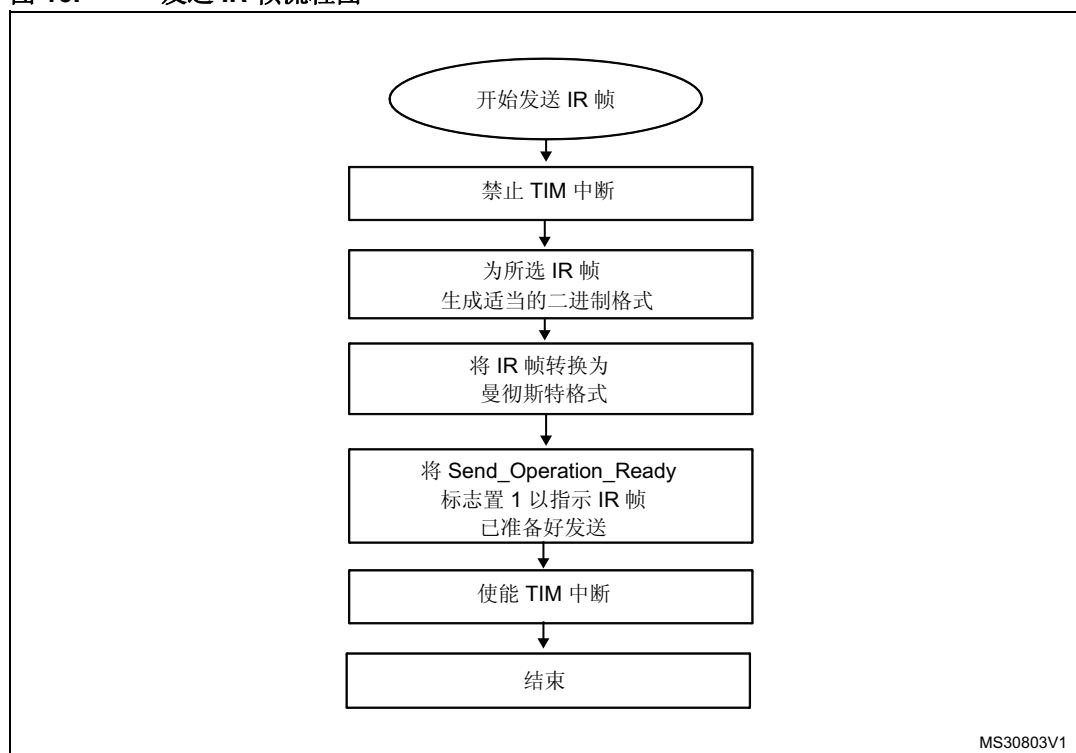
图 10. 发送 IR 帧流程图
